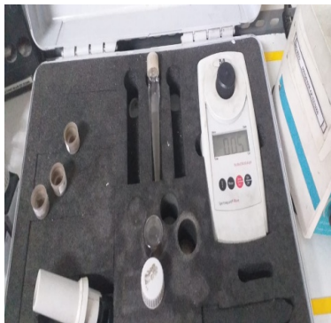
Gambar 2.2 Pengujian klorin depot Pasuruhan
